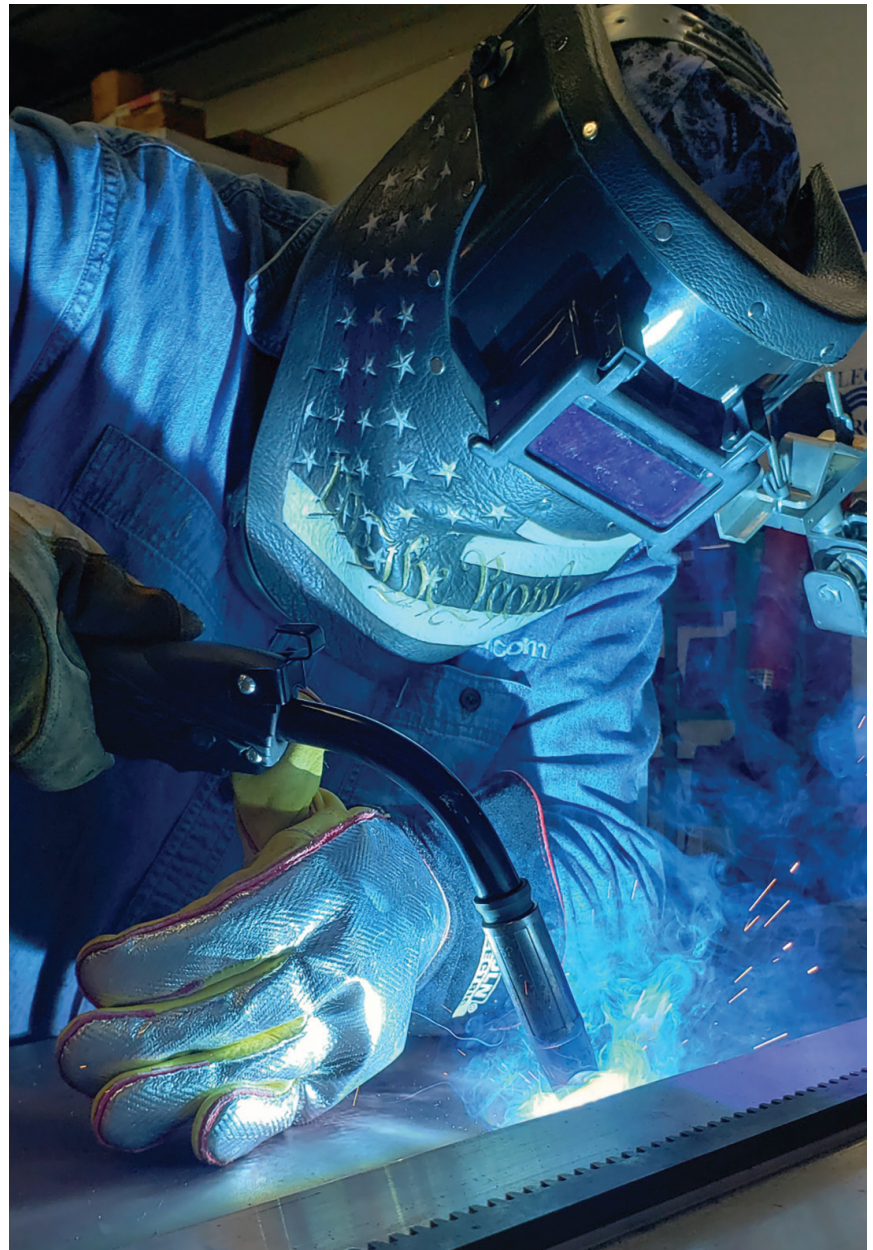
Jason Becker hace una soldadura FCAW-G para desarrollar un registro de calificación de procedimiento.
