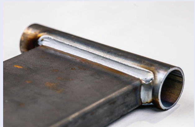
En las fotos se muestra la soldadura por arco automatizada y una pieza terminada.
