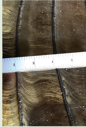
Fig. 6 — Observaciones de una aplicación de revestimiento de tiras de soldadura por arco sumergido (SAW) de acero al carbono utilizando un electrodo de tira EQNiCr-3 (Inconel® Weldstrip 82), 60 mm (2.36 pulgadas) de ancho × 5 (0.196 pulgadas) de espesor. Flujo: Registro de flujo básico aglomerado NFT 201.
