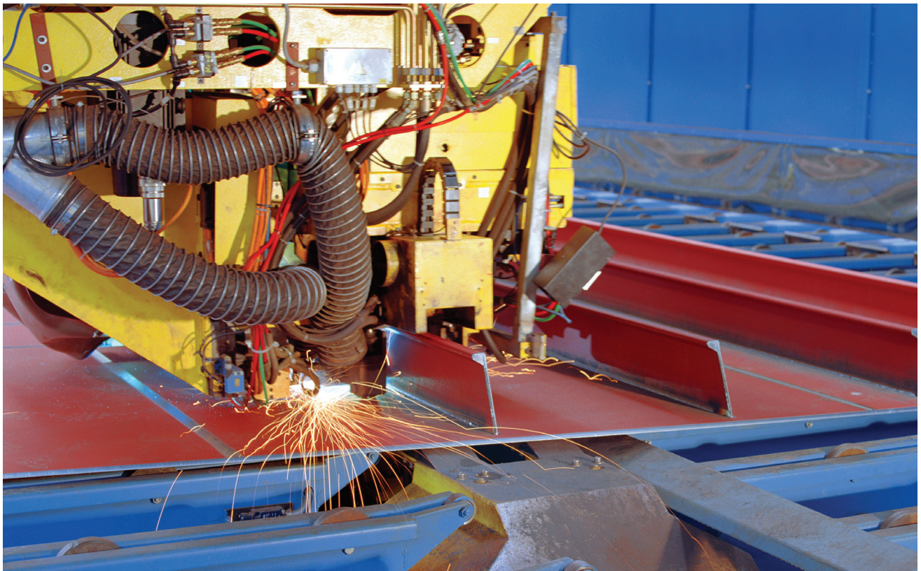
Fig. 1 – La soldadura láser combinada con GMAW es un proceso de soldadura híbrido que se utiliza a menudo en la construcción naval. (Foto cortesía de TRUMPF.)
