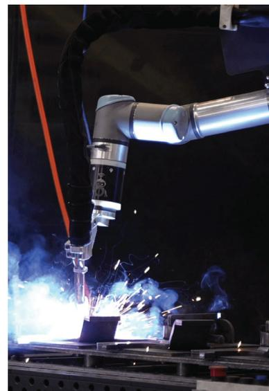
**Fig. 3 — Los cobots de IMS ayudan a la empresa a lograr soldaduras de calidad consistentes y repetibles.**
