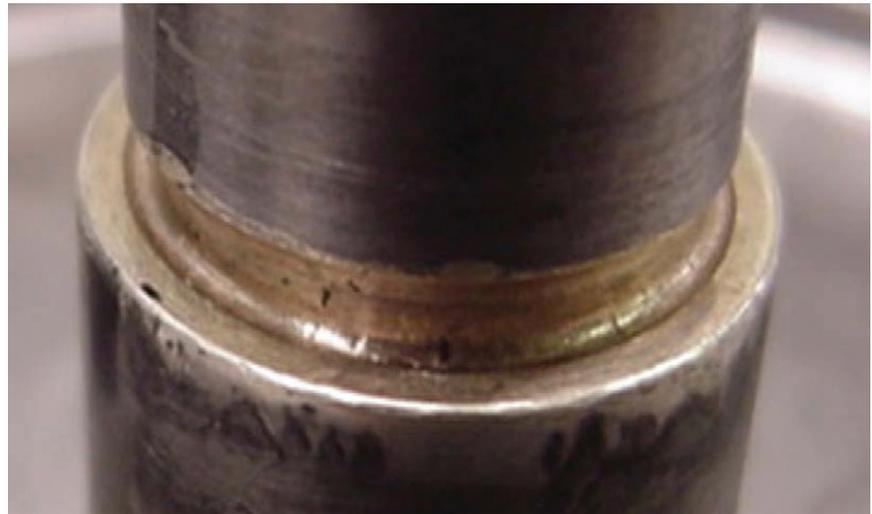
*Fig. 1 – unión tubular soldada que muestra el menisco hundido (filete).*
