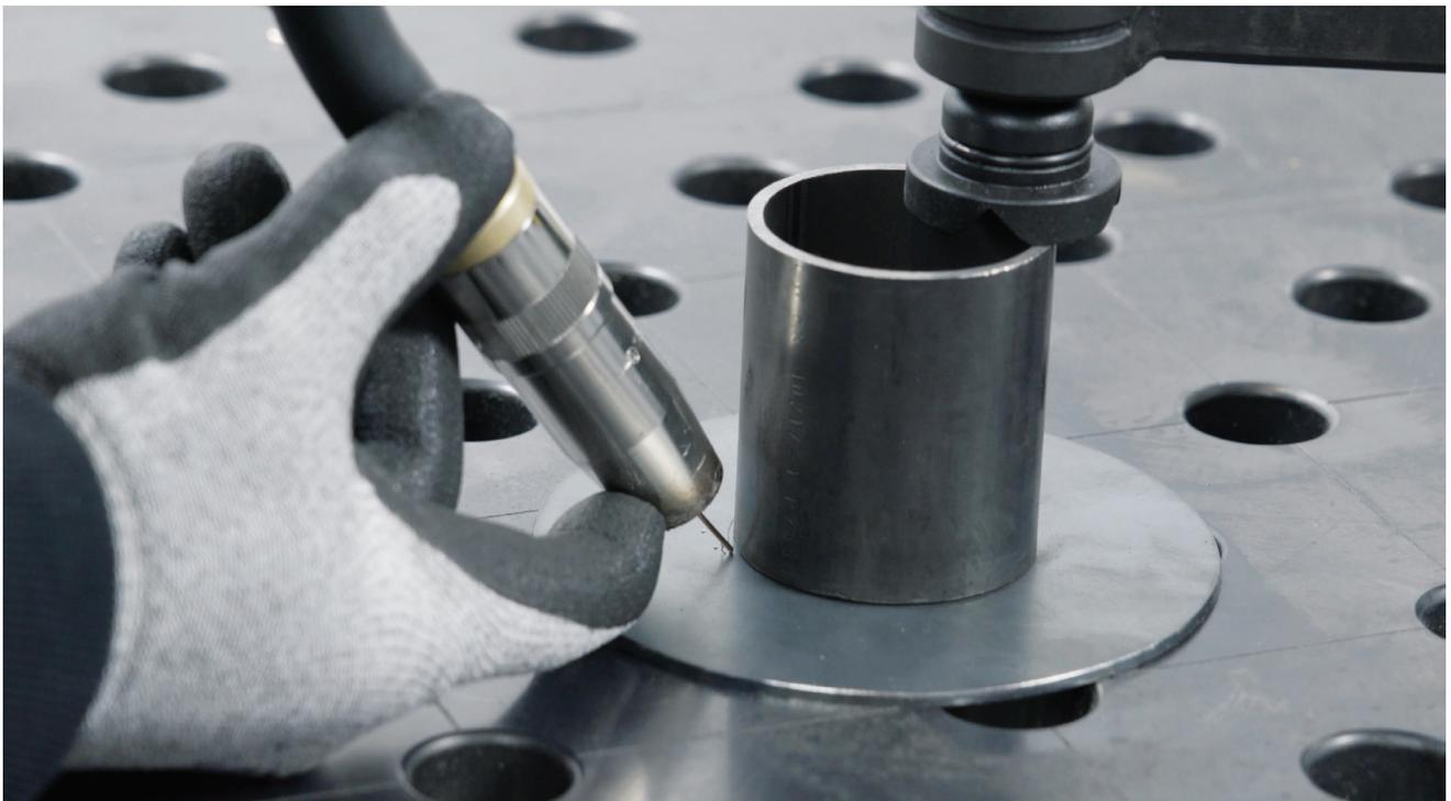
*Los métodos de programación sencillos, como la programación directa, permiten a los usuarios puntear y soldar piezas moviendo físicamente el brazo del robot a través de las rutas de soldadura deseadas, esencialmente enseñando al cobot el movimiento de soldadura necesario, que luego puede replicar con solo presionar un botón. (Foto cortesía de ABB Robotics).*
