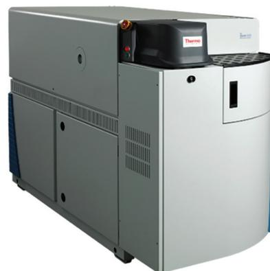
El espectrómetro de emisión óptica (OES) del analizador de inclusiones ARL iSpark™ 8860 viene con el paquete de software Spark-DAT para brindar una cobertura elemental completa y una caracterización rápida de inclusiones no metálicas en un solo análisis. Puede identificar y determinar características como el tipo, el número, el tamaño, la concentración y la fracción de volumen de las inclusiones, lo que permite a los fabricantes controlar el contenido de inclusiones en los productos de acero
