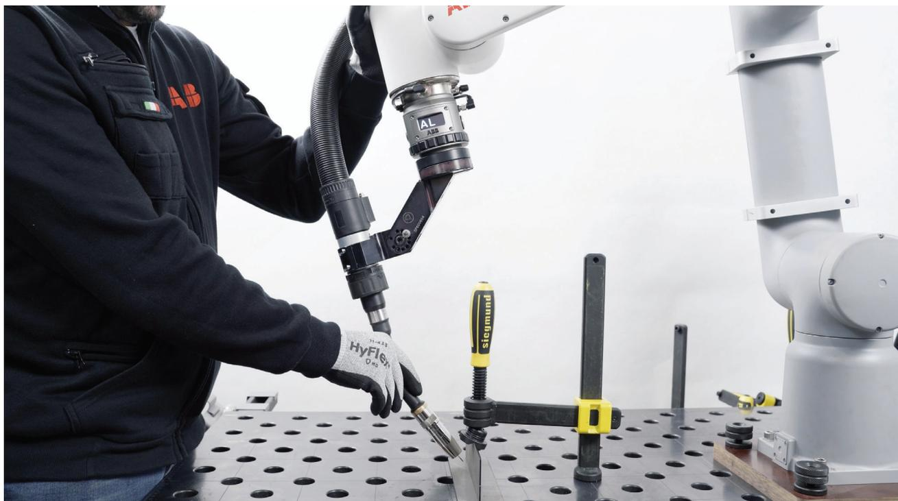
*El dispositivo de aprendizaje fácil lleva la programación directa al siguiente nivel, lo que permite soldaduras de alta calidad en piezas más complejas. (Foto cortesía de ABB Robotics).*
