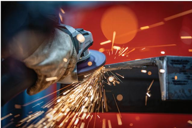
Fig. 3 — Use una presión moderada y deje que la rueda haga el trabajo. La orientación de la rueda con respecto a la pieza de trabajo también juega un papel importante en el rendimiento y la productividad.
