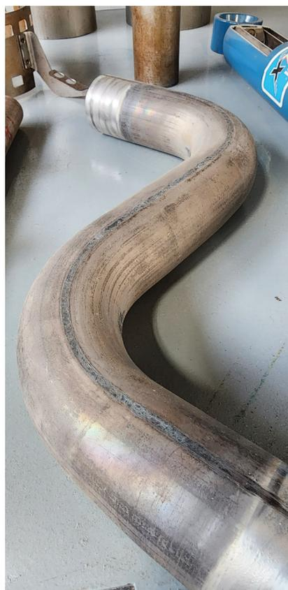
*Tubería soldada por resistencia. (Crédito de la foto: Koops Automation/Newcor.)*
