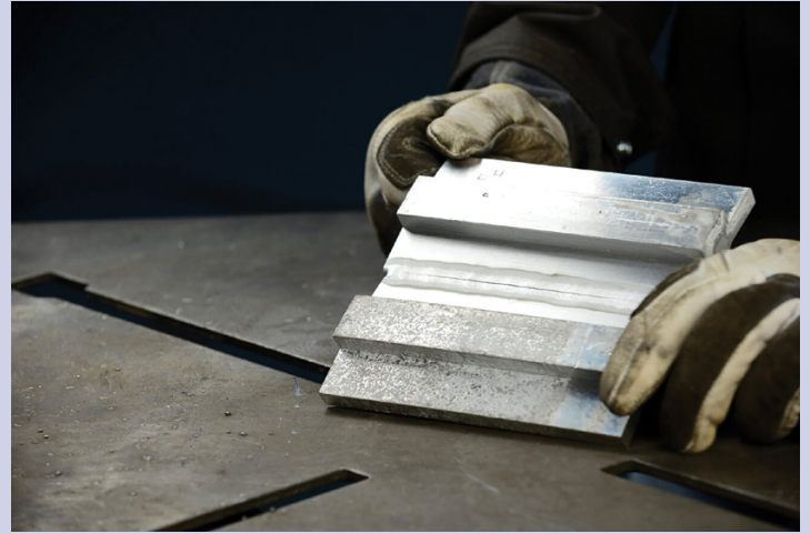
(foto izquierda) Un operador de soldadura utiliza soldadura por arco de tungsteno con gas para fusionar placas de aluminio. (derecha) Un operador de soldadura sostiene una unión terminada fusionada con metal de relleno de aluminio Hobart.
