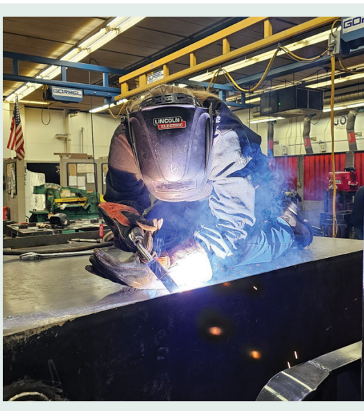
(extrema izquierda) Murray repara un compresor de aire con un agujero en la parte inferior.
