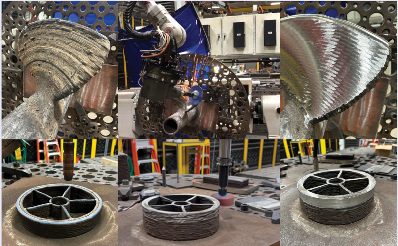
Fig. 4 — Ejemplos de geometría nociónal multiproceso fabricados con arc-DED y operaciones de acabado realizadas con el husillo en el sistema de pórtico Navus. © EWI. Imagen utilizada con autorización.
