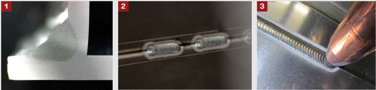
Fig. 1 — Perfil de penetración de junta adecuado para soldadura de aluminio. Fig. 2 — Las funciones especiales, como el arranque en caliente y el relleno de cráteres, ayudan a iniciar el baño de soldadura y evitan la fusión al final. Fig. 3 — La alternancia de la potencia del arco crea una soldadura cosmética ondulada y reduce la entrada de calor para minimizar la distorsión.
