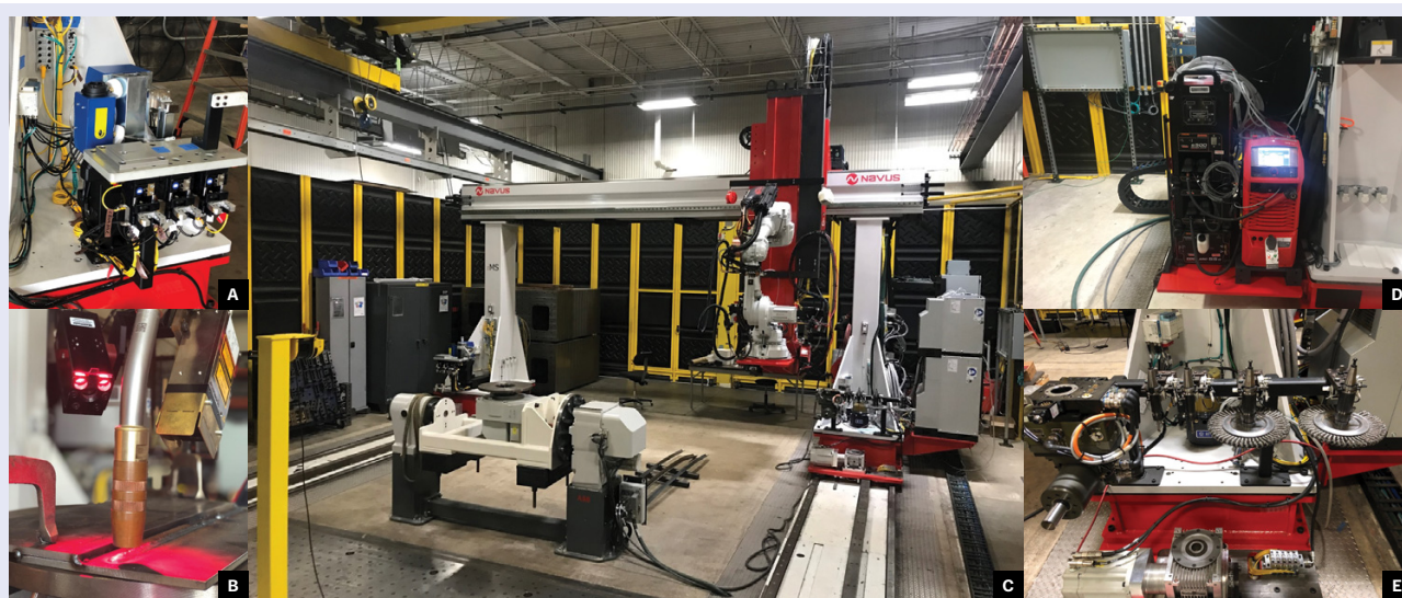
Fig. 2 — sistema híbrido de pórtico DED con arco robótico multiproceso integrado por Navis Automation: A: mantenimiento de antorcha Binzel y diana ABB; B: antorcha equipada con sensores; C: pórtico; D: fuentes de alimentación Lincoln Electric y Fronius; E: husillo y estación de herramientas PushCorp. © EWI. Imagen utilizada con autorización.
