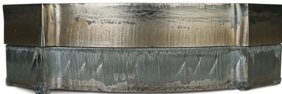
Fig. 1 — Acero suave de 1 pulgada cortado con la unidad de corte con plasma XPR300® (arriba) contra una unidad de corte con láser de fibra de 8 kW (abajo).
