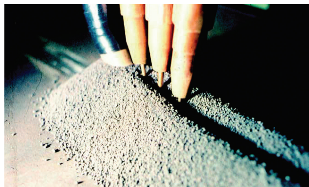
Acercamiento del fundente usado en la SAW. (Crédito de la foto: Welding Handbook, novena edición, volumen 2, Welding Processes, Parte 1.)
