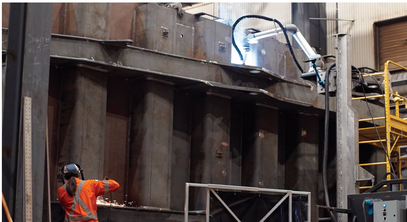
Fig. 3 — un robot UR10e GMAW está montado en un séptimo eje y colocado en un patín móvil para llevar el robot a piezas de trabajo grandes. Un soldador humano y un soldador robótico trabajan codo con codo, saltando por el lateral de la carrocería del camión para duplicar la producción.
