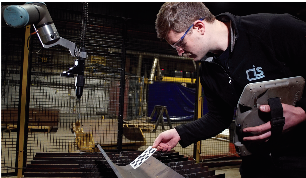
Fig. 2 — Mason Fraser programa la aplicación de corte por plasma utilizando un tablero de ajedrez para calibrar el sistema de visión.
