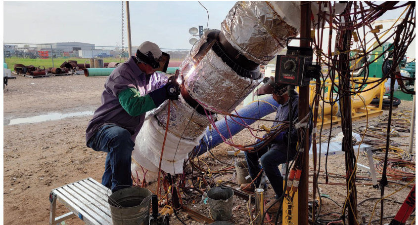
Maqueta de tratamiento térmico de campo (izquierda) y prueba de tubería. (Fotografías cortesía de Legacy Heat Treatment y Republic Testing Labs).
