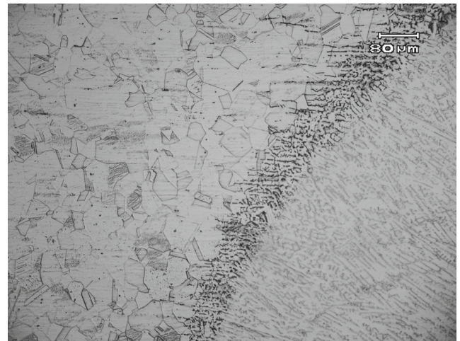
Indentaciones de dureza en una muestra de soldadura (arriba, foto cortesía de Legacy Heat Treatment and Applied Inspection Systems) y estructuras de grano de una réplica de superficie.
