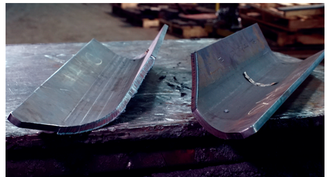
Fig. 1 — Una comparación de una pieza cortada manualmente (izquierda) y una pieza cortada con robot (derecha) muestra la eliminación de la escoria y los bordes dentados que ya no necesitan limpiarse con el robot.
