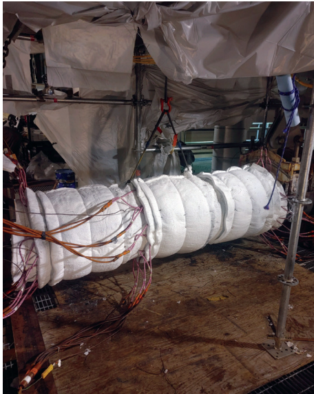
Maqueta de tratamiento térmico de campo (izquierda) y prueba de tubería. (Fotografías cortesía de Legacy Heat Treatment y Republic Testing Labs).
