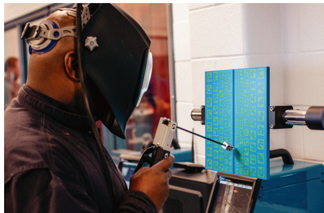
Fig. 5 — un estudiante usa AR para perfeccionar sus habilidades de soldadura por arco de metal protegido sin desperdiciar cupones de metal ni consumibles. (Crédito: Lewis and Clark Community College.)
