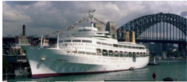
Fig. 11 — El SS Canberra , Circular Quay, Sydney, Australia, “The Great White Whale” (la gran ballena blanca) tenía una superestructura de aluminio totalmente soldada. (Foto cortesía de la Colección de embarcaciones John Ward, enero 1984.)
