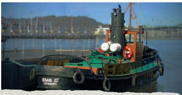
Fig. 5 — El primer navío de clase totalmente soldada aprobado de Lloyd, construido en 1921 (Foto cortesía de Jerry Mirgáin, 2009.)
