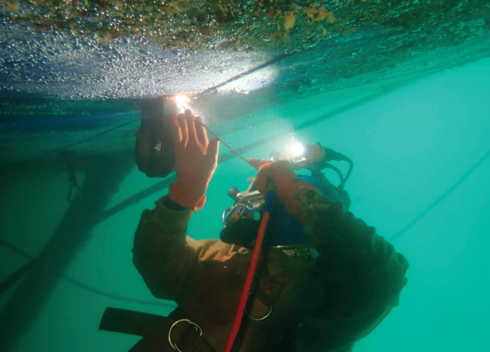
Fig. 3 — Un soldador/buzo de Phoenix instala cáncamos en un barco de la Marina de los Estados Unidos para reemplazar un cojinete.
