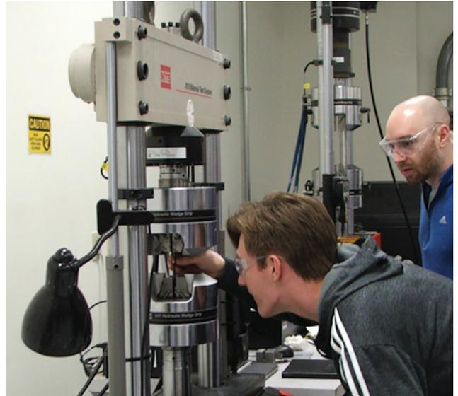
Los estudiantes del curso WE 7123 en OSU, alrededor de 2020, instalaron una máquina de prueba para medir la resistencia al corte de una muestra soldada de acero inoxidable.
