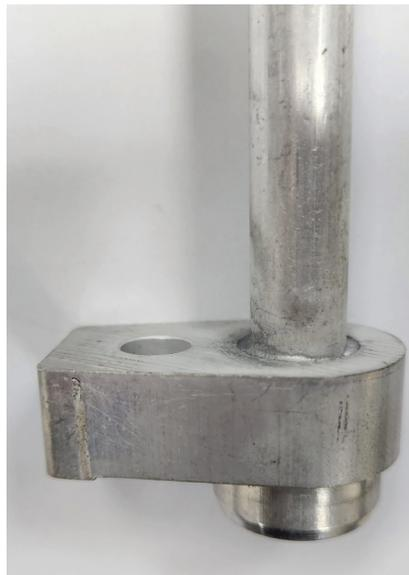
*Fig. 3 — Aspecto posterior a la soldadura fuerte de una junta hecha con Al 718 y fundente corrosivo después de que se eliminaron los residuos con un enjuague con agua caliente. (Foto cortesía de SK Brazing).*
