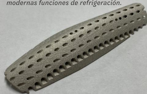
*Preformas 3D con funciones de refrigeración diseñadas y producidas para la reparación del VGN AE2100.*
