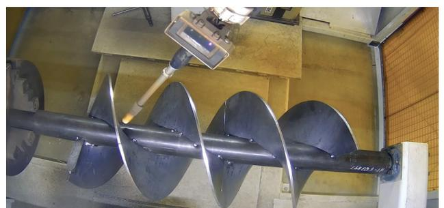
Fig. 1 — es posible coordinar el movimiento simultáneo de un barreno y una antorcha para crear un cordón uniforme y continuo. (Captura de pantalla del canal de YouTube de ABAGY, vídeo de barrenado).
