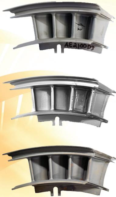
Un AE2100 NGV con daños en el perfil aerodinámico, después de soldar y después de mezclar y recubrir.
