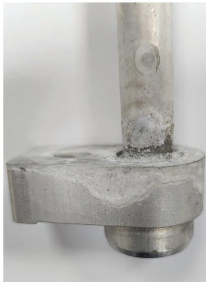
*Fig. 2 — Aspecto posterior a la soldadura fuerte de una junta hecha con Al 718 y fundente no corrosivo. (Foto cortesía de SK Brazing).*
