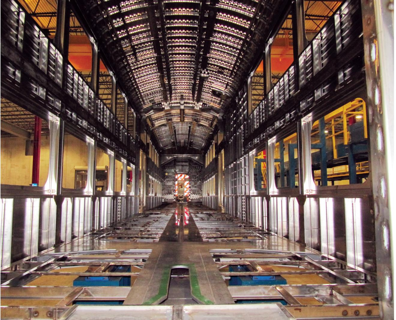
Interior de carrocería de acero inoxidable con el 90% de la estructura realizada mediante soldadura por resistencia.
