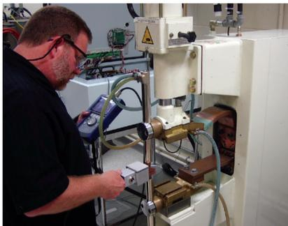
*El operador utiliza un monitor de soldadura para verificar el proceso durante la producción.*
